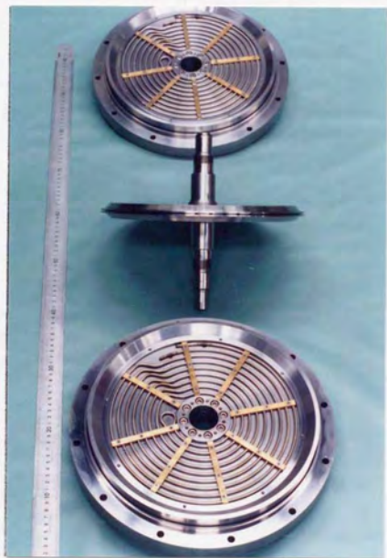
図 5 - 3 試作装置のロータとステータを分解した写真
