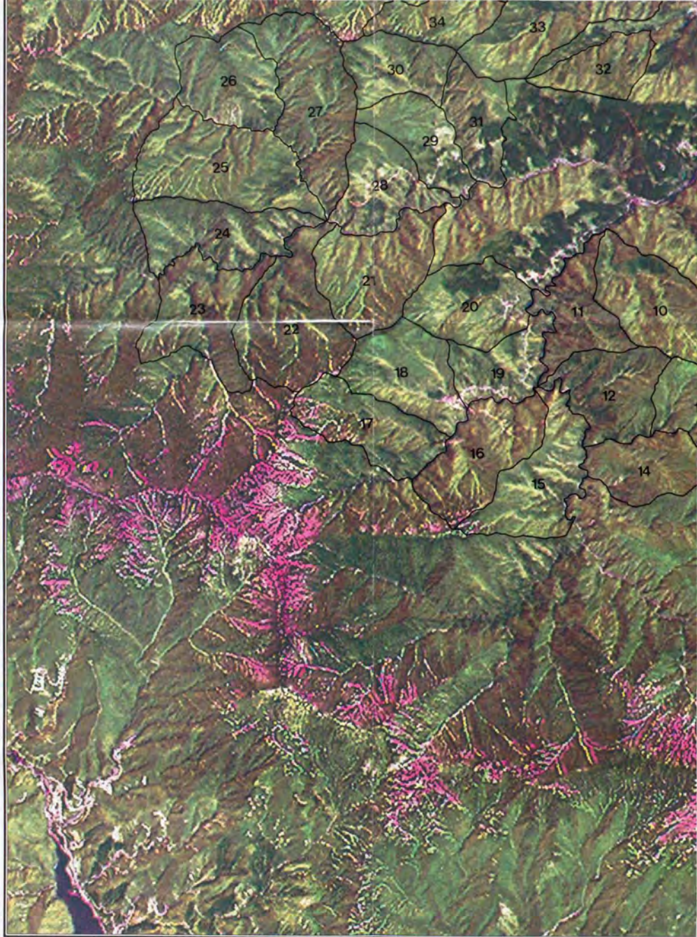
この画像マップは、1992年4月23日に撮影されたLandsat・TM画像(解像度30m、Band 3:赤、Band 5:緑、Band 1:青)と、1991年4月4日に撮影されたSPOT・HRV-P画像(解像度10m)を地形データを使って輝度補正し、RGB-HSV変換によって重ね合わせたものです。
