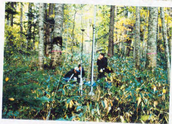
図Ⅲ-4-3 移動局でのGPS測位の様子
