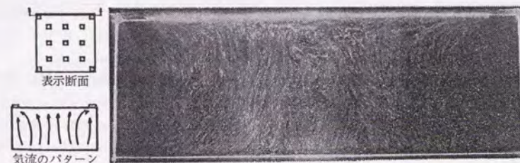
図1.6 Type 2（天井面給排気方式）の壁面近傍鉛直断面
