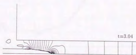
図 4.7: 各時刻における等圧力線図、列車先頭部が楕円形の場合
