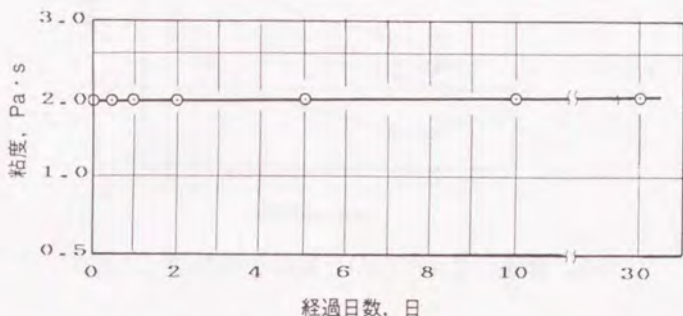
図5.12 粘結材粘度の経時変化(30°C)
