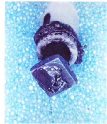
図2-9 Y123単結晶を種結晶としてa-軸方向に成長した結晶の外観写真。
