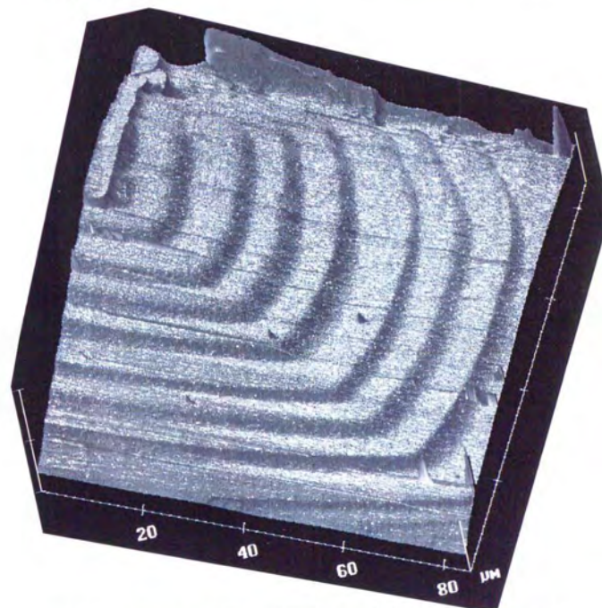
図3-12 結晶の(100)面上で観測された多角形の成長ステップのSTM像。
