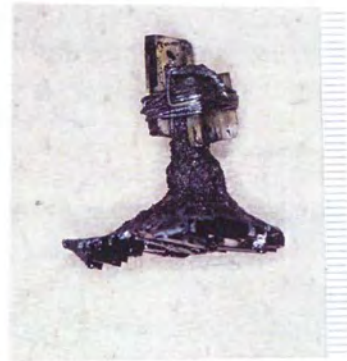
図3-3 [100] 方向に成長させた場合の結晶の外形の例。水平面内の長辺方向が [010] 方向を持つ長方形に近い形状の結晶が集合した結晶の塊である。
