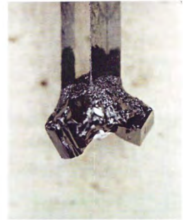
図2-7 光学研磨したマグネシア単結晶の(100)面から成長した結晶の外観写真。
