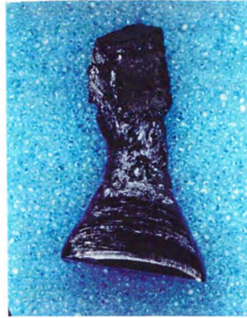
図2-6 Sm123相配向結晶から成長した結晶の外観写真。
