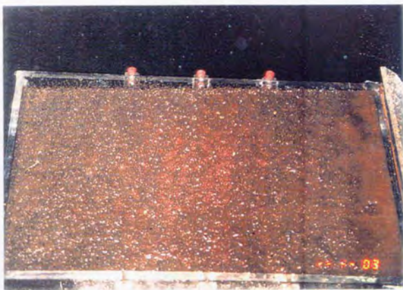
(d) 降雨開始後32分 (降雨開始後32分で亀裂が消滅し、地表面流出が発生している)
