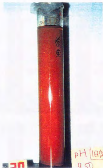
Photo VII-1 pH9.5の土壤懸濁液の沈降開始後24時間後の様子
