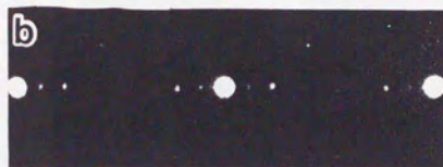
図 3. 5. 3 空気及び Ar 中で焼成された \text{Bi}_2\text{Sr}_2\text{Ca}_{0.4}\text{Y}_{0.6}\text{Cu}_2\text{O}_{8+y} の電子線回折パターン (a) 大気中 1183 K 焼結 (b) Ar 中 1093 K 焼結
