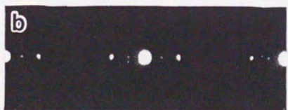
図 3. 5. 4 空気及び Ar 中で焼成された \text{Bi}_2\text{Sr}_2\text{Ca}_{0.2}\text{Y}_{0.8}\text{Cu}_2\text{O}_{8+y} の電子線回折パターン (a) 大気中 1183 K 焼結 (b) Ar 中 1093 K 焼結
