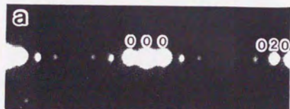
図 3. 5. 3 空気及び Ar 中で焼成された \text{Bi}_2\text{Sr}_2\text{Ca}_{0.4}\text{Y}_{0.6}\text{Cu}_2\text{O}_{8+y} の電子線回折パターン (a) 大気中 1183 K 焼結 (b) Ar 中 1093 K 焼結
