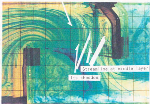
図4.3.1 岬周辺の流れの可視化（表中層と下層の流跡線が明らかに異なる）
