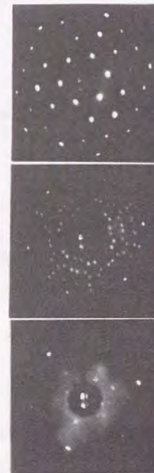
図6.4 (2×2)、 (\sqrt{19} \times \sqrt{19})R23.4^\circ 、(1×1)に再構成したGaAs(111)B表面のLEED像。図中に入射電子線のエネルギーを示した。
