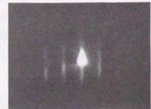
図3.1 GaAs(100)-c(4×4)表面のRHEED像。電子線は[011]方向より入射した。
