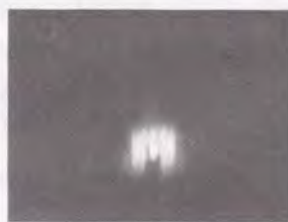
図3.5 Ga安定化表面にTMGを照射している最中に観測される (1 \times 8) を示すRHEED像。電子線は [011] 方向より入射した。
