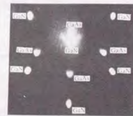
図5.15 GaN選択成長マスクのRHEED像。立方晶の単結晶であることを示す。GaNは薄いので、GaAs基板からのRHEED像が残っている。
