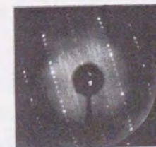
図4.1 ここで用いたGaAs(100)-c(4×4)表面、(2×4)表面、(1×6)表面のLEED像。入射電子のエネルギーを図中に示した。
