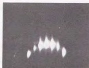
図3.6 再現性よく形成できる(2×4)表面におけるRHEED像。電子線は[011]方向より入射した。
