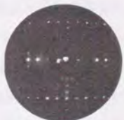
図4.11 (100)-(2×4)表面を様々の処理温度まで昇温することで得た表面ストイキオメトリの異なるGaの過剰なGaAs(100)表面のLEED像。図中に処理温度と再構成構造を示す。
