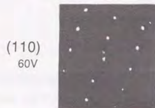
図6.1 GaAs(110)表面のLEED像
