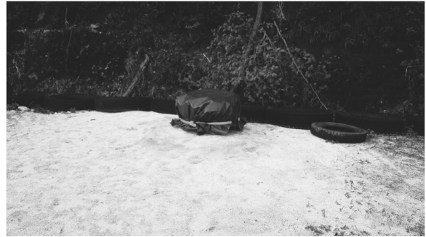
図 13. 完成し、養生された地震計台 マンホール上部には FRP 製のフタを置き、チェーンと南京錠でフタをロックして児童があやまって落ちることのないようにした。最後に耐候性のグリーンシートを被せて雨避けにし、目立たないようにした。
