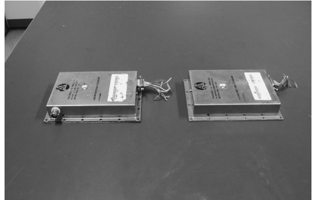
図2. 改良によりBNCレセプタクルを取り付けたFE-5680A(U/N35332, 左)及び取り付けしていないFE-5680A(U/N37658, 右)。
