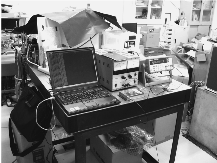
図 3. (上) 周波数計測のブロック図. (下) FE-5680A 出力信号の周波数計測の光景. 机上, HP53132A (右), 安定化電源 (中奥), FE-5680A (U/N23651, 中手前) 及び計測周波数記録用 PC (左).
