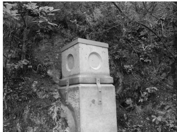
図 5. 岩着された地震計台（馬場平観測点）。鉄製のふたの上部には取手がついている。
