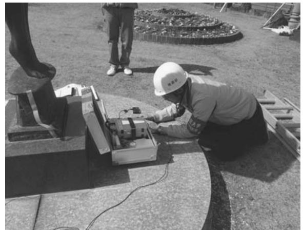
図 36. 本部棟前中庭モニメント基礎台に設置した地震計
