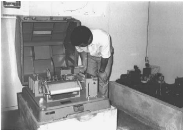
図1. SMAC-A型強震計 右、USC & GS標準強震計（幅740×長840×高600mm×重量300kg）
