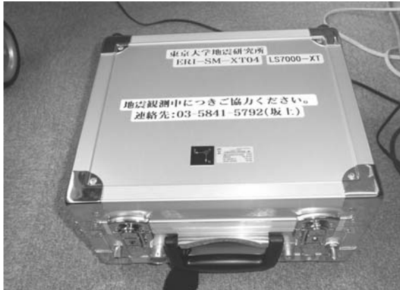
図 24. ポータブル地震計(320W×270D×160mmH:重量8.5kg)
