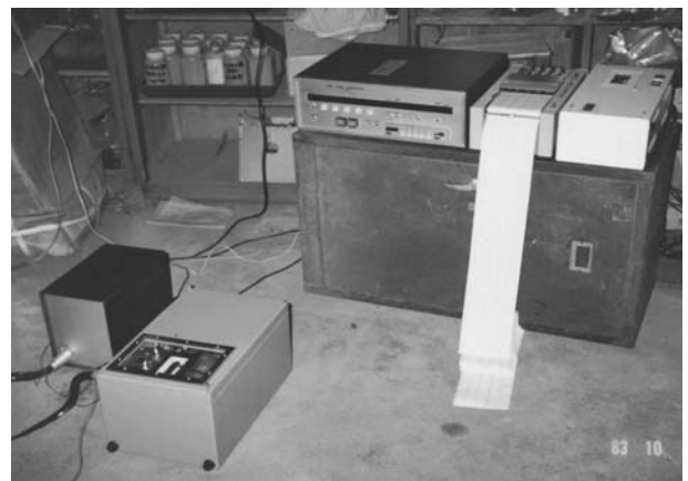
図 23. 1983 年三宅島での機動観測の様子。左手前: 強震計と電源部、後方: 時刻較正時計と記録再生装置
