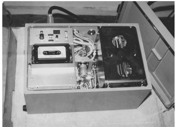
図4. 駿河湾・伊豆観測網に導入したSMAD-1型強震計（幅250×長400×高210mm×重量20kg）
