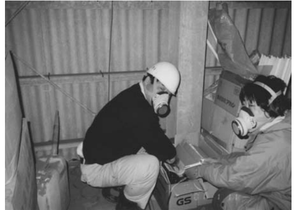
図 25. 三宅島噴火:三宅村役場観測点でのバッテリー交換
