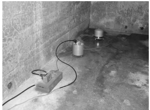
図 11. トンネルの奥に設置した地震計 (2台)。奥は STS-2 地震計。手前は L-4C-3D 地震計。
