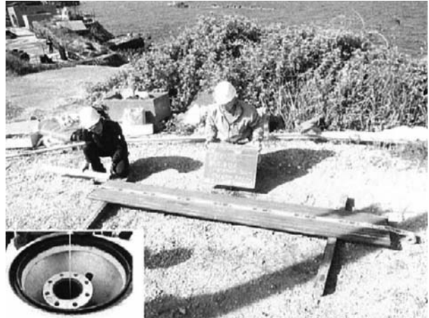
図 38. 掘削に用いたロッド管の検尺と左下掘削深さの検尺確認
