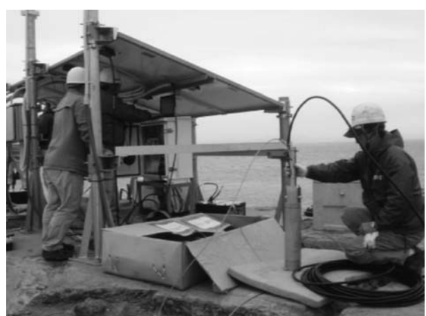
図 40. 地中地震計埋設直前に行なった地震計の動作チェック
