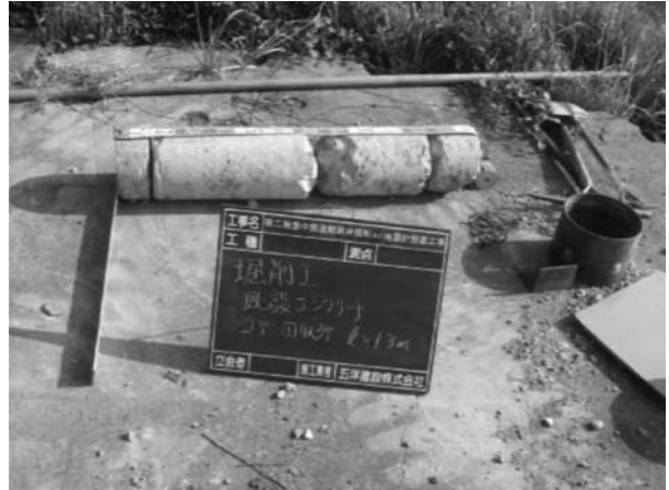
図 21. 旧円形状砲台跡地からの掘削コンクリート片
