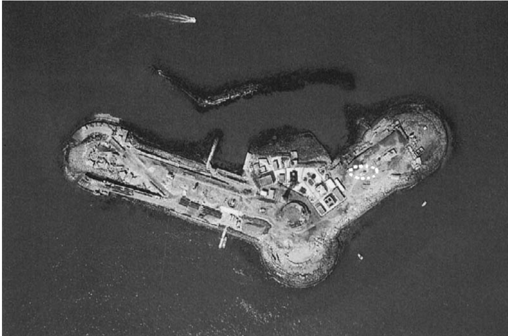
図 56. 2009 年 9 月現在の第二海堡の全貌。左辺：護岸工事状況。中央：海上保安庁の消防訓練施設。右辺：国交省波浪観測所と○印：地震研海堡地震観測点が見て取れる。航空写真：国交省提供による
