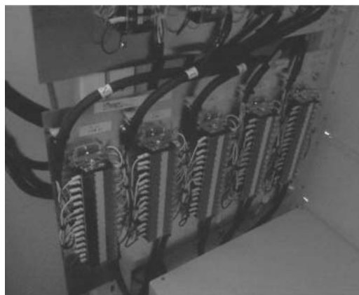
図 12. 基板収納ラック中に増設した A/D 基板 (左)・各検出器からの信号ケーブルの接続 (右)
