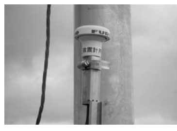
2006.3 GPS アンテナ設置状況
