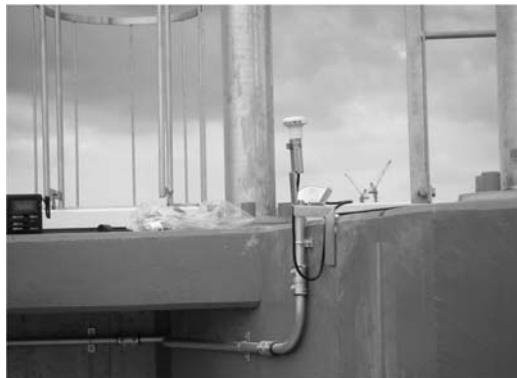
図 10. 屋上のアンテナ塔に設置した GPS (中央部はアンテナ支持柱で横に GPS アンテナ)
