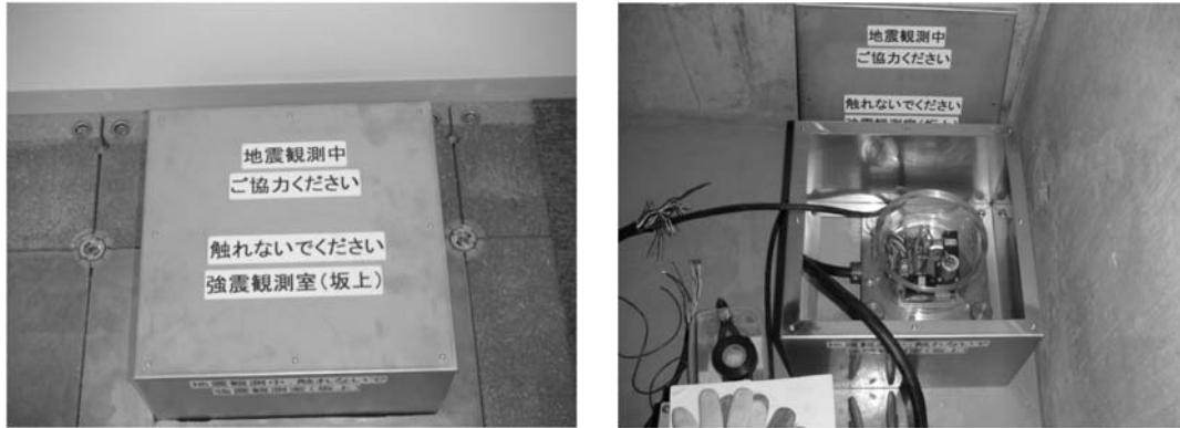
図 6. 自作のステンレス製カバー（左）、保護カバー内部の検出器取付け状況（右） （事務部庶務チーム隅に取付けた加速度計カバー・教材用に開発したアクリル製検出器カバー）
