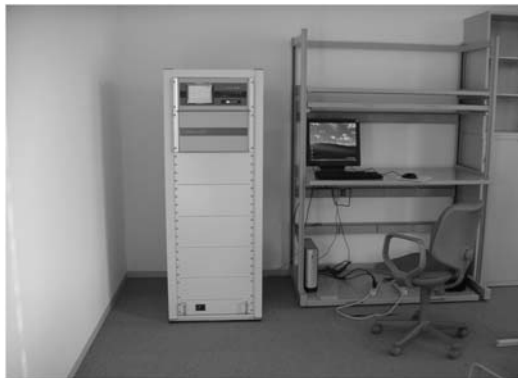
図 9. 1 号館 512 に設置した多成分収録装置 (多成分収録部本体 (左), データの自動収集 PC (右))
