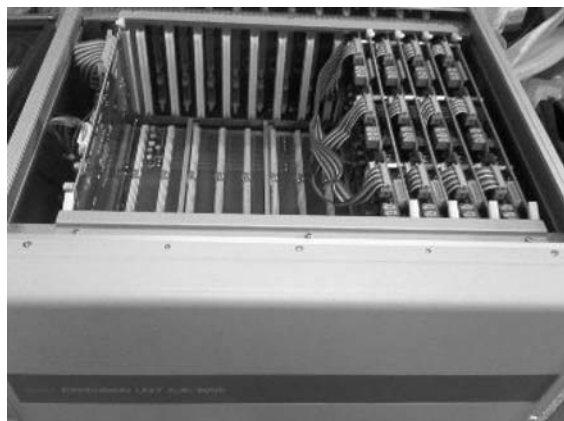
図 12. 基板収納ラック中に増設した A/D 基板 (左)・各検出器からの信号ケーブルの接続 (右)
