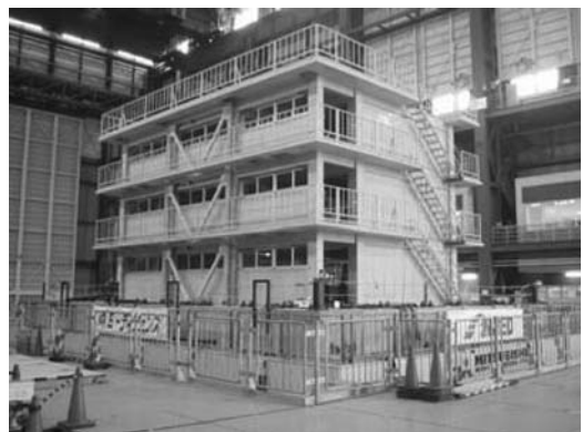
図 7. 耐震補強を施している試験体
