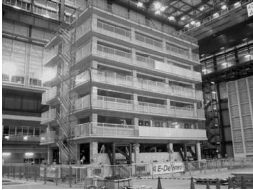
図 4. 6層の実大試験体
