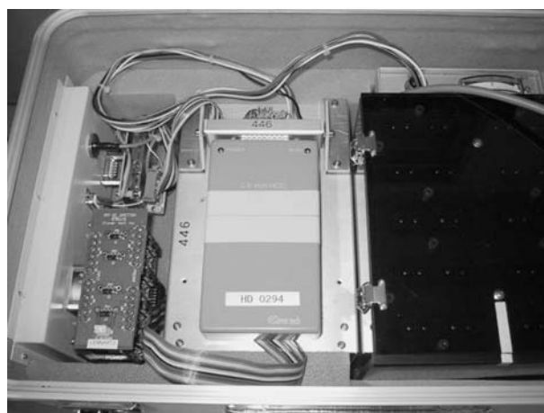
図 2. DAT-4 型レコーダ内部
