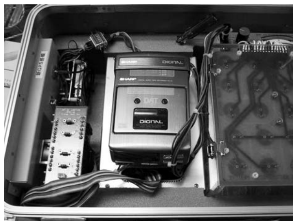
図 1. DAT-2GC 型レコーダ内部
