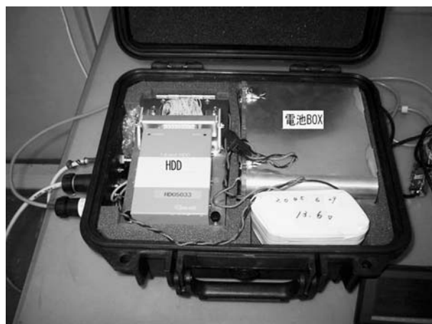
図 4. DAT-5 型レコーダ内部
