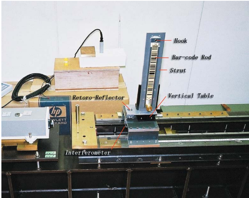
図 3. 30 cm 検定用標尺の設置状況
