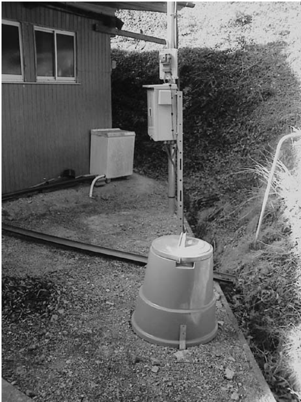
図 4. 観測点全景 手前の円筒形容器内に地震計が入っている
