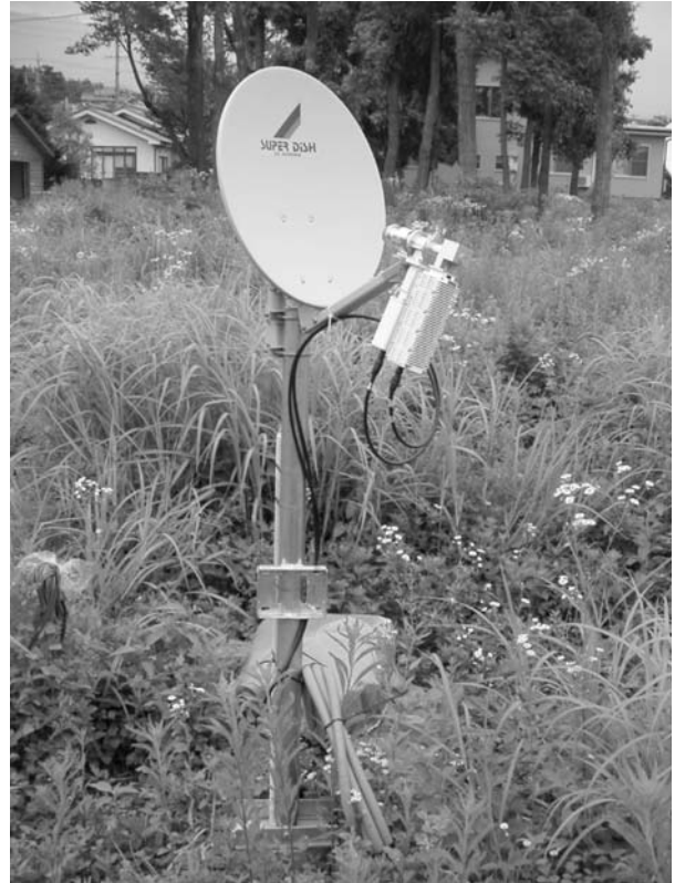
図3. 小諸支所で試験運用中のSAOサービスVSAT。これは試作品の45cmアンテナ。IDUはアンテナポールの向こう側にある、シートに包んだ容器に収容されている。
