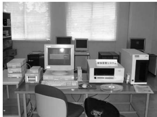
図 1. 名古屋大学情報連携基盤センターの媒体変換装置 “nucv”。ワークステーションの右に MT のドライブが設置されている。ドライブの前に置かれているのが本稿で扱った MT のメディア。
