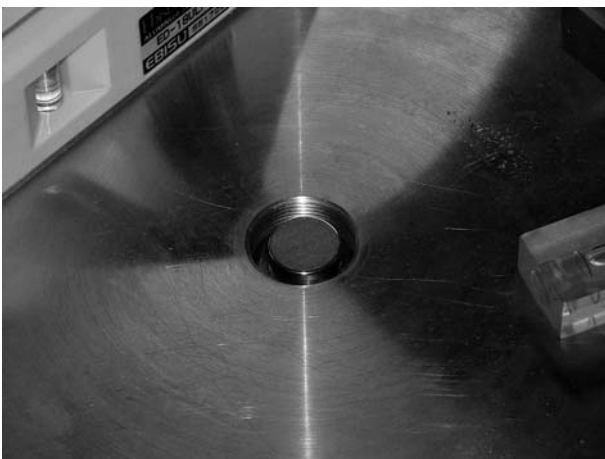
図 12. 三角台磁石設置部分の中央に設置された磁石
