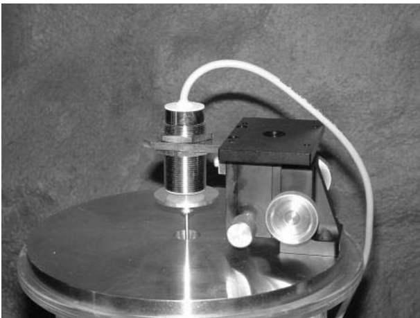
図 23. Z 軸ステージに取付けられたリニアセンサー
