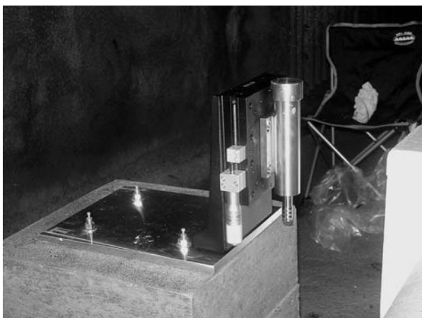
図 10. 中間台座に取付けられた検定部
