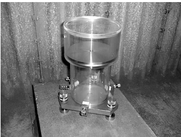
図 6. あらかじめ観測坑内に仮設置したガラスポット一式
