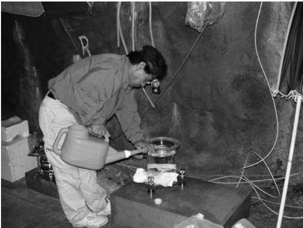
図 17. ガラスポットに蒸留水の注入
