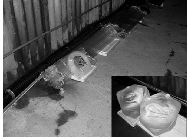
図 7. あらかじめ観測坑内に搬入された蒸留水・連通管・シリコンチューブ
