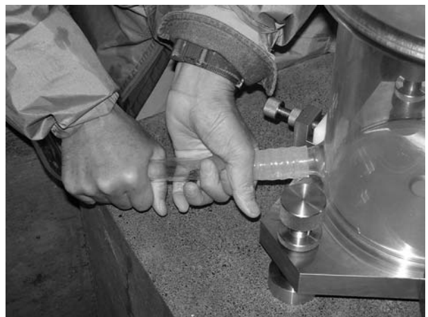
図 15. シリコンチューブでガラスポットと連通管の接続
