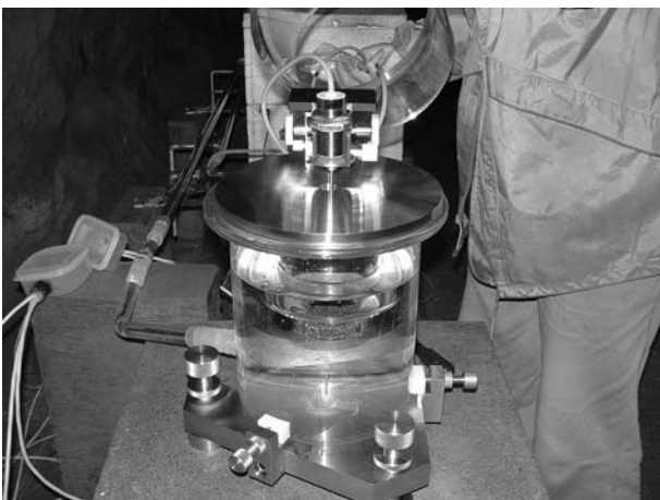
図 24. 設置が終了しアクリル円筒を乗せて設置完了
