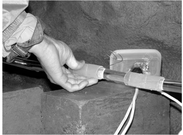
図 19. 連通管に入り込んだ気泡の除去作業
