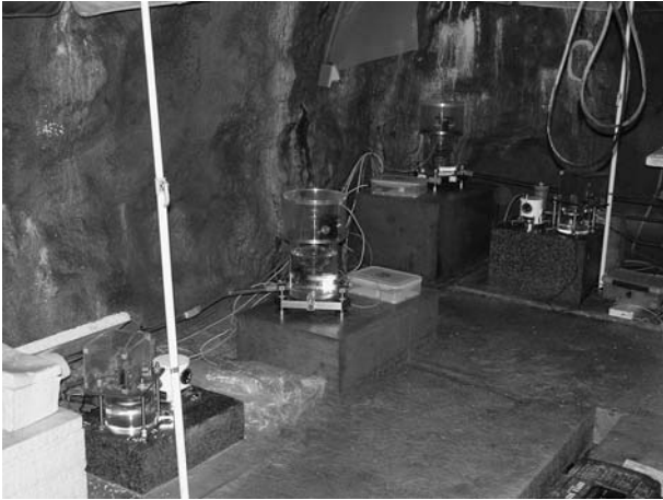
図 27. 既存台石に設置されているフロート型・読取型水管傾斜計と新規台石に設置された 90 型水管傾斜計 (B 端・C 端付近)
