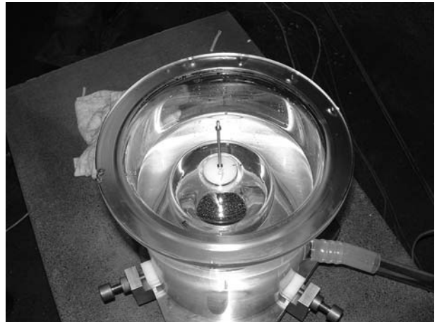
図 20. 蒸留水の入ったポットに浮かされたフロート
