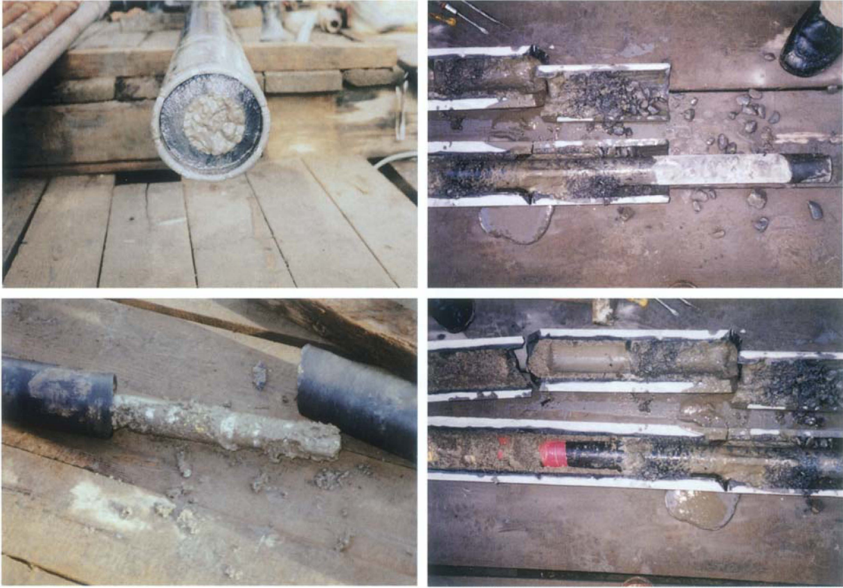
図 2. 回収されたコアの写真. 左上はコアバーレル内に収納されたコア, 他の3枚はコアを剥がした時の写真でモルタルは硬化しなく残留沈殿物やモルタルのゲル状が確認された.
