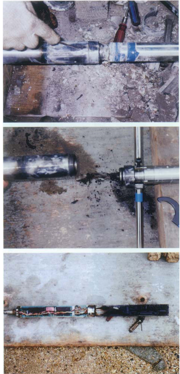
図 3. 上の写真は、ビットが焼き付いた部分を取除いている。測定装置は高熱で変色している。下は基板が焼けて黒焦げになり電池は潰れていた。
