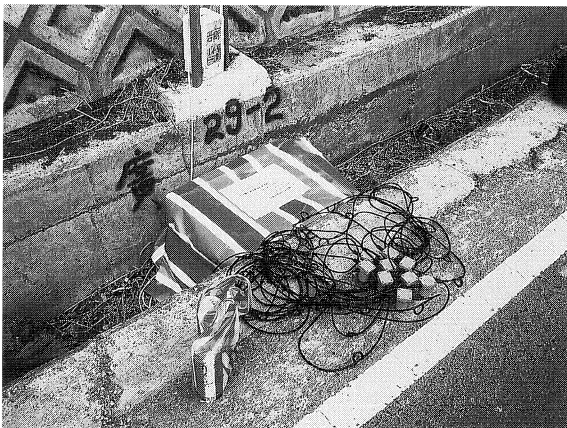
図 17. Station No. 29-Ch2 の設置点 アスファルトに孔を開けて設置された地震計.
