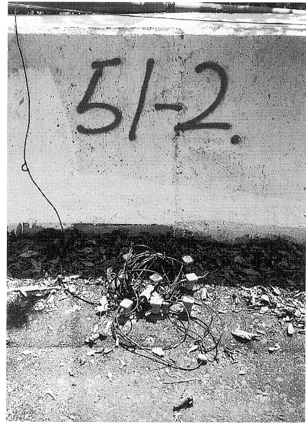
図 19. Station No. 51-Ch2 の設置点 アスファルトに孔を開けて設置された地震計.
