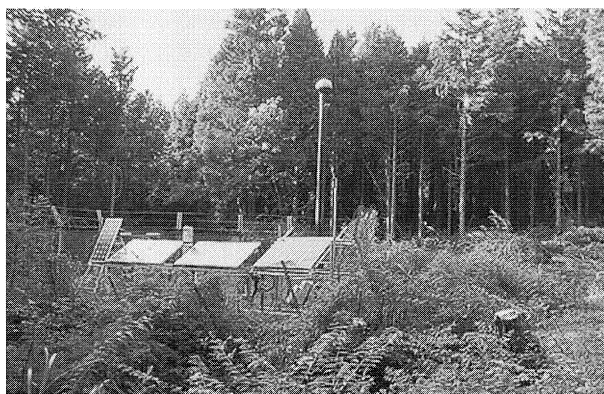
図 8. 富士山観測点完成. 右側の太陽電池モジュールが GPS 観測用, 後方が地上 5m のアンテナ架台.
