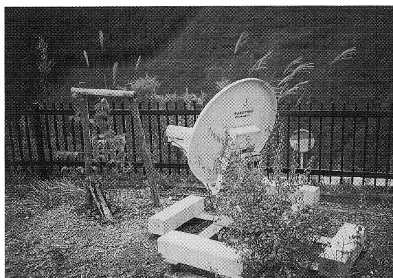
図 7k. 名古屋大学蓮ダム事務所の庭に設置された衛星観測用パラボラアンテナ
