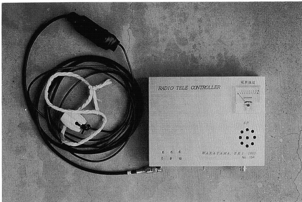
図 12. 図 11 の基板をケースに実装した状態。アンテナを含む。
