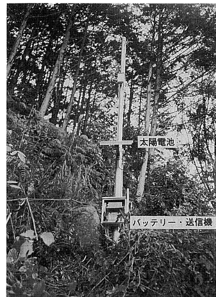
図 14. 1 チャンネル型有線方式 FM テレメータシステムの設置例 電源はバッテリーと太陽電池 (30 W) によって賄われる.
