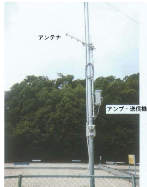
図 9. 1 チャンネル型 FM-FM 無線テレメータの設置例 アンテナは八木・宇田型 5 素子，その下にアンプ・送信機のボックス。消費電力は約 5 W（年間電力料として約 600 円）。
