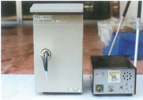
図 7. 1 チャンネル型 FM-FM テレメータシステム 左がアンプ・FM 変調器・送信機（400 MHz 帯，1 W），右は受信機・復調器。
