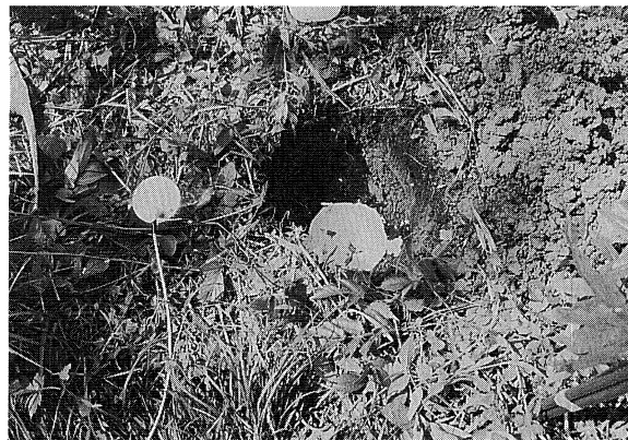
図 4. 地面に地震計が埋まる程度の穴を掘り、石膏を流し込み、水平と方位が固定できたら動かないように土で埋める.
