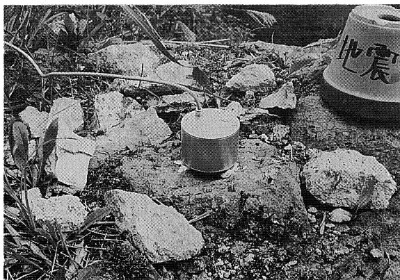
図 3. 地震計の設置できそうな岩盤上で、水平と方位を決めたら石膏などで固定する.
