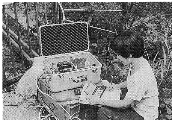
図 9. テープ交換作業風景。2 人一組で行うのが間違いも少なく望ましい。
