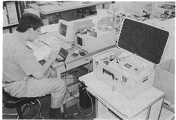
図2 信越観測所で観測使用前のDATレコーダー点検作業風景
