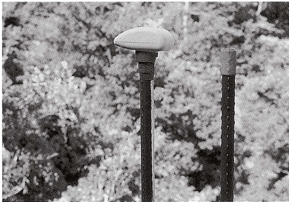
図 5. GPS アンテナは、ボールの先に布テープを巻き径の隙間をなくしてアンテナを差し込み、さらにビニールテープを巻いて固定すると抜けることはない。
