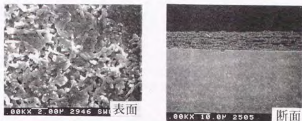
図3-2-13 YBa 2 Cu 4 O 7 膜の表面及び断面SEM像
