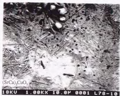
図2-7-2 酸素濃度1%中で部分溶解させた試料をオイルクエンチにより凍結させた組織 (昇温過程)
