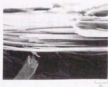
図 2-4-1 液体窒素クエンチ試料のSEM及びXRDパターン
