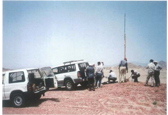
図 44. 観測点の設置。約 3 m の角材が受信アンテナ用ポールである。
