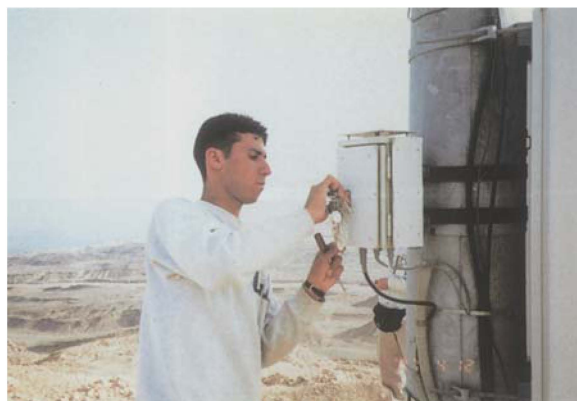
図 79. NABA 観測点 [FM-FM 型送信機 (瀬戸製)]. この送信機は 1ch 専用機であるので、ダイナミックレンジ が 4Ch のものより大きい。
