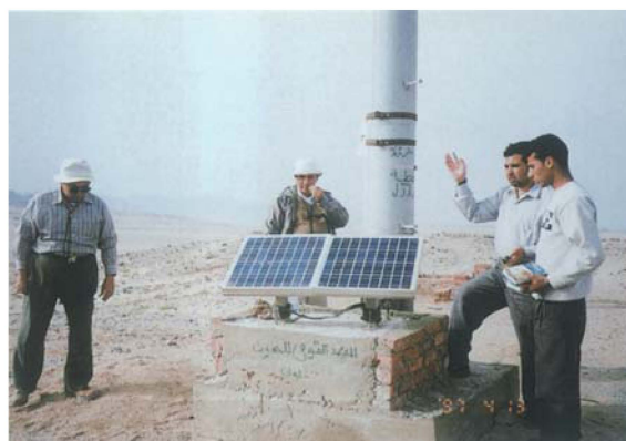
図 78. NABA 観測点 (FM-FM 型上下動 1ch). この観測点は NRIAG 独自で設置した。SHRM と ABSH の 2 つの中継点を通して伝送される。
