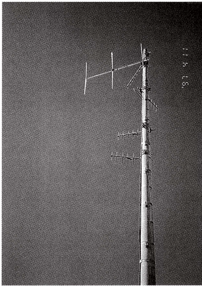
図 43. HAMM 観測点のパンザマストにつけられた 68.00 MHz 用 3 素子八木アンテナ。この場合は測線が直線のため、無指向性のアンテナではなく指向性のアンテナを使用した。下段の 4 アンテナは固定局用 402 MHz 帯アンテナである。
