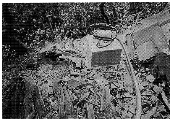
別置地震計台への検出器 (加速度計) の設置
