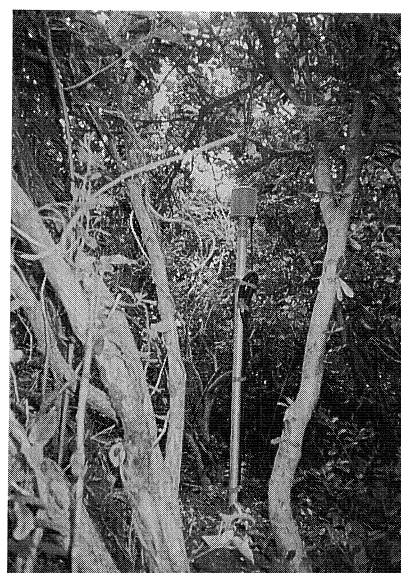
プロトン磁力計の設置状況 (手石島東側の平坦地樹木の中)
