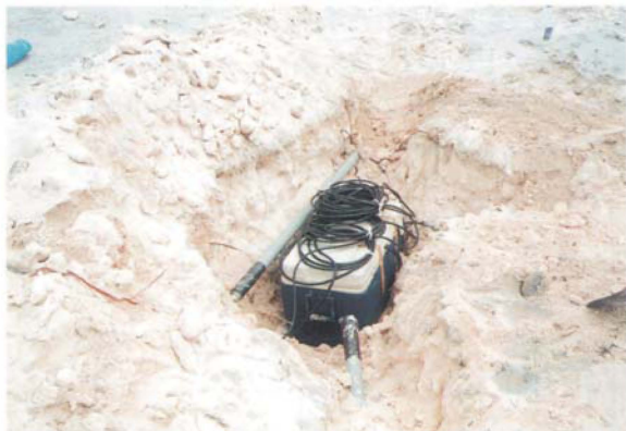
図 4. プロトン磁力計計測部、フラックスゲート磁力計計測部とジャンクションボックスを収納したクーラーボックス。温度変化の影響を除くため、1mの深さに埋設した。
