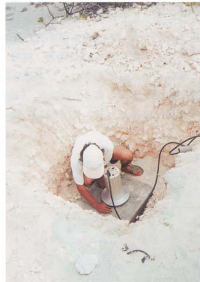
図 6. フラックスゲート磁力計センサーの設置状況。さらにプラスチックケースをかぶせた上で埋設（深さ1m）した。
