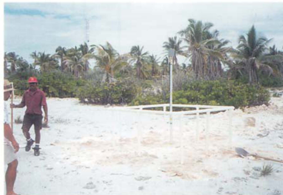
図 5. プロトン磁力計のセンサー設置状況
