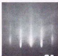
図3-2 6 MBE装置中での基板温度上昇前（1の時点）の RHEEDパターン。エッチングが300℃で3分間の場合。 電子線は [011] 方向の入射。
