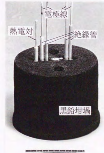
図3-11 電極ならびに熱電対の取付状況（高融点合金）
