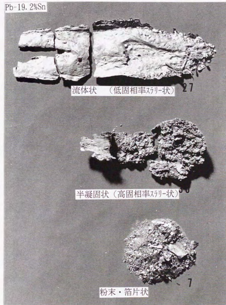
図4-7 S C R材の外面性状 (Pb-19. 2%Sn)
