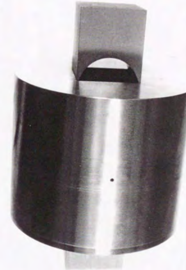
図 5-71 半溶融鍛造金型 (半溶融押しビレット作製用)
