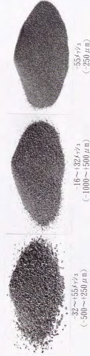
図 5-41 半溶融攪拌冷却法により製造されたA5056粉末
