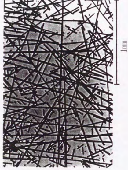
図5-80 半溶融押出しにより得られたFRM棒材 内部の強化繊維の長さ
