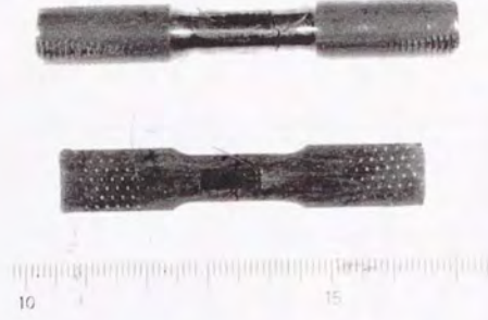
図5-83 FRM板材・FRM棒材から 作製した引張り試験片の形状
