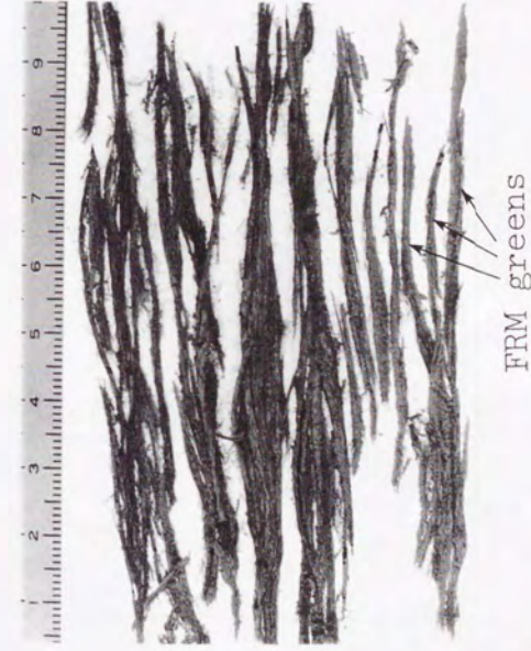
図5-73 押し出し延伸法により棒状に製造されたFRMグリーン
