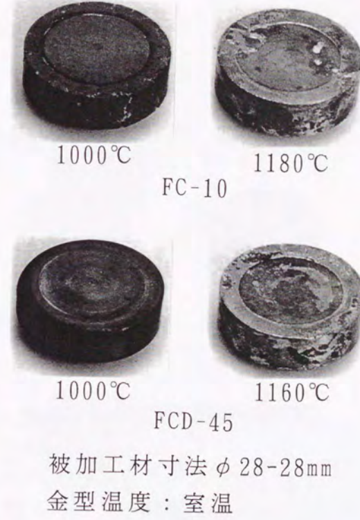
図 6-3 製品の外面性状におよぼす鍛造温度の影響 (2)
