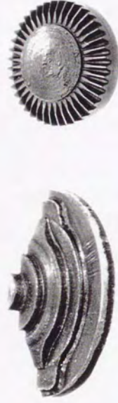
図 6-3-3 半溶融鍛造法により製造された 粒子強化複合材料製品例
