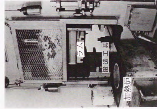
図 6-37 積層型粒子強化複合材料製造装置と工具の概観
