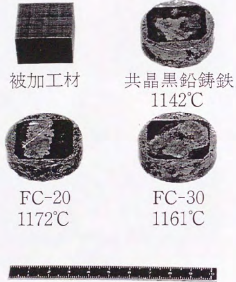
図 6 - 4 半溶融鍛造による 各種鑄鉄の製品例
