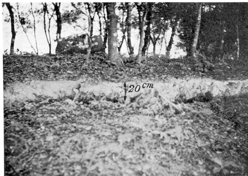
第 136 圖 菘麻園。Fig. 89 の北方約 1 軒の山稜に現はれた地裂， 方向 N 20^{\circ}E ，東側約 20 釐沈下。
