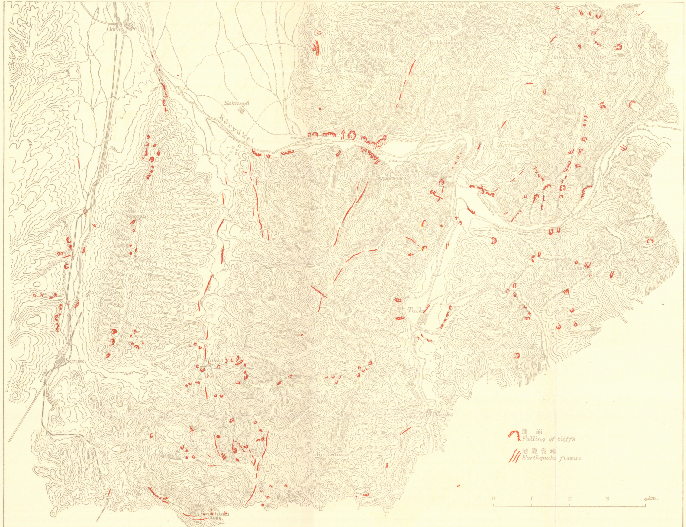
第25圖 臺灣中部地震(1935)の際に生じた地震裂隙, 崖崩の分布圖(其2)
