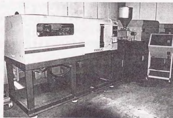
図5.5 実験に使用した射出成形機 （ファナック㈱：AUTOSHOT MODEL 75E）
