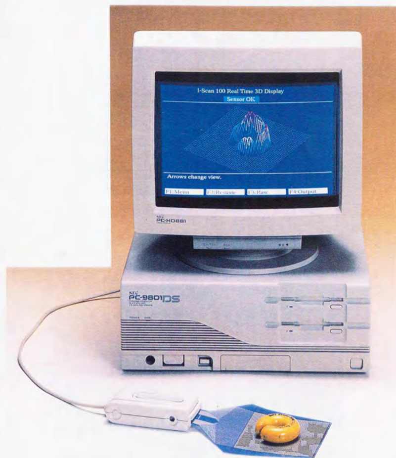
図7.6 タクトイルセンサ計測システムの外観 120)
