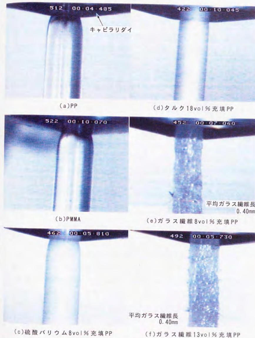
図3.13 各種樹脂のダイスウェル挙動観察画像 (せん断速度 91\text{s}^{-1} )
