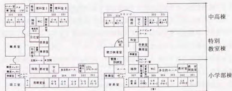
〔図3-2〕 校舎の棟分離例
