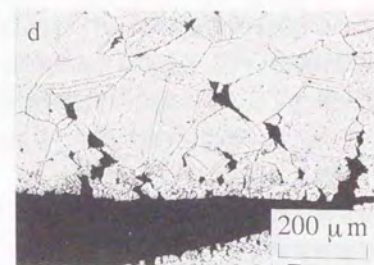
図2-13 クリープ座屈後の試験体の断面観察結果 (平均肉厚3.89mm、平均初期偏平率6.16%、外圧力5MPa)
