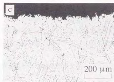
図2-13 クリープ座屈後の試験体の断面観察結果 (平均肉厚3.89mm、平均初期偏平率6.16%、外圧力5MPa)
