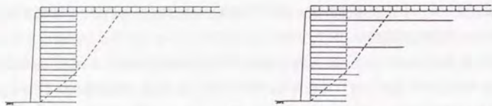
図-3.4.2 剛壁面 (ケース①) の補強材配置
