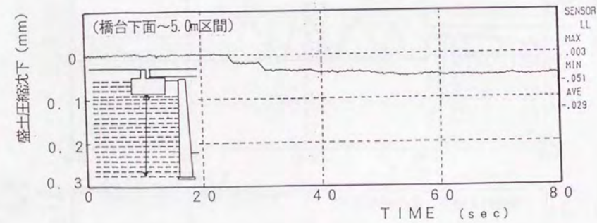
図-4.2.25 盛土内沈下計 (動的計測)
