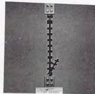
写真-3.6.10 クリープ試験状況
