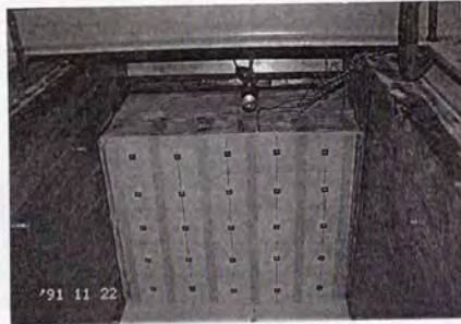
写真-5.1.11 ブロック壁面効果実験：前面掘削完了
