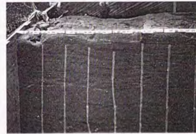
写真-5.1.20 相似率実物大実験：実験後の盛土解体
