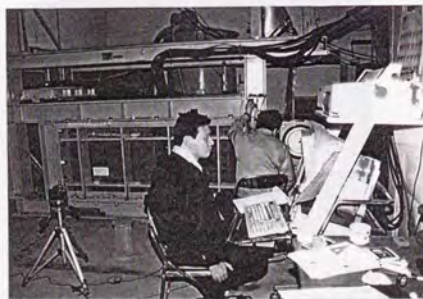
写真-5.1.13 クリープ実験：計測状況
