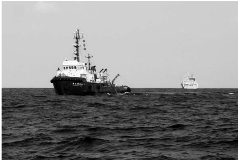
写真 震源域の海上で実施した二船式反射法地震探査。ケーブル船（写真後方）は長さ1.2kmのストリーマーケーブルを曳航するとともに480 cu inchのエアガンで直近の浅層部のデータを取得した。同時に1500 cu inchのエアガン（写真手前の船舶に搭載）を遠距離から発震し、より深部のデータを取得した。
