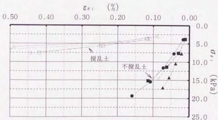
側圧（不攪乱土）×：0.0kPa ●：30kPa ▲：50kPa ■：70kPa 側圧（攪乱土）+：0.0kPa ○：30kPa △：50kPa □：70kPa 図5-42 不攪乱土と攪乱土の比較（内周の応力～ひずみ関係）
